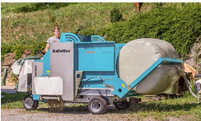
Mittels Ladegabel wird der Rundballen angehoben.
